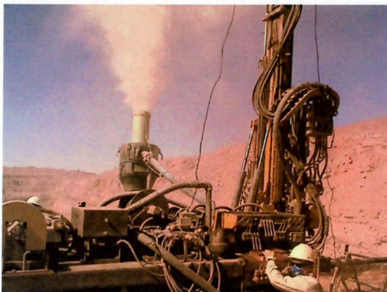
Figura 5: Perda de finos pela parte superior do ciclone
